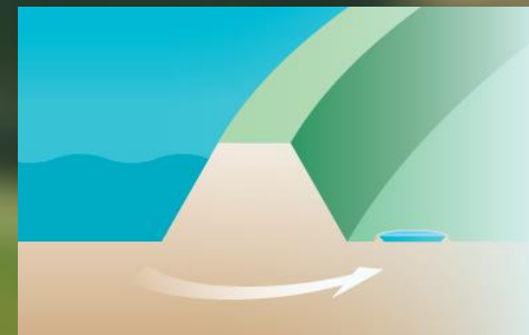
Piping (stroomt water onder de dijk)
