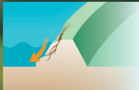
Erosie door beschadiging van de dijkbekleding
