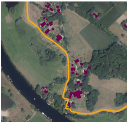
Uitsnede deeltraject 16 ter hoogte van Haerst. Hier ligt vaak bebouwing (paars) dicht tegen de dijk (oranje)
