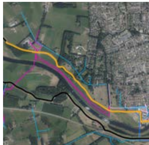
Overzicht van de ligging van riolering (roze) en drinkwaterleidingen (Blauw) langs deeltraject 10 (Oranje).
