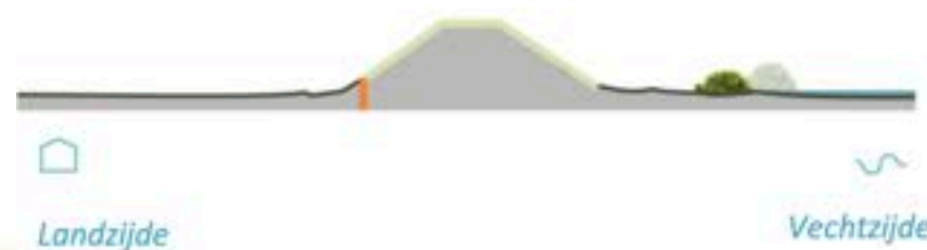
Figuur 5-1 Principeprofiel dijkversterking binnen het huidige dijkprofiel
