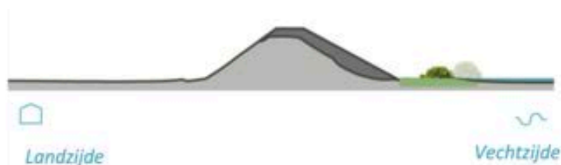
Figuur 5-3 Principeprofiel dijkversterking buitendijks
