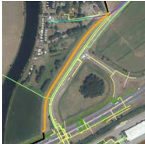
Kabels en leidingen t.h.v. Deeltraject 15. Groene en gele kleuren geven de ligging van kabels weer.
