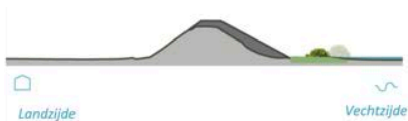
Figuur 5-3 Principeprofiel dijkversterking buitendijks
